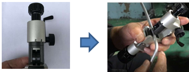
輪切りでの回転刃セット図
