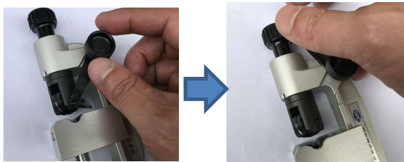
輪切りでの回転刃セット図
