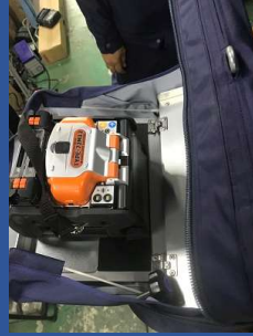
融着機本体のテーブル固定状態
